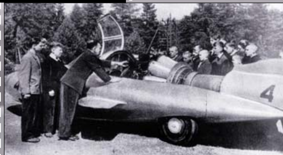
А. Смолин демонстрирует школьникам из Дворца пионеров в Горьком машину ГАЗ-СГ3. Хорошо видны боковые антикрылья и реактивный двигатель.
