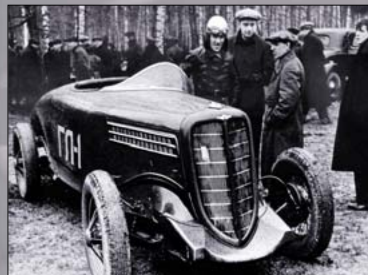
ГАЗ-ГЛ1 1938 года с 4-цилиндровым мотором. Шасси – ГАЗ-М1, колёса – от ГАЗ-А.
