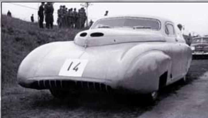
ГАЗ-20-СГ1 1955 года В. Метелева с двигателем без компрессора.
